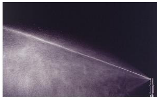
Aspersor com baixa qualidade de aplicação de água
