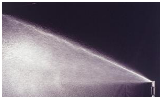
Aspersor com jato de água com boa uniformidade de aplicação
